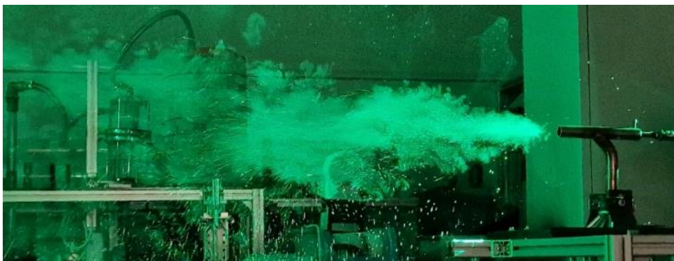
Abbildung 2.4.8: Verhalten des Teststaubes bei der Dosierung mittels der eigens entwickelten Dosieranlage Figure Abbildung 2.4.9: Dosieranlage
