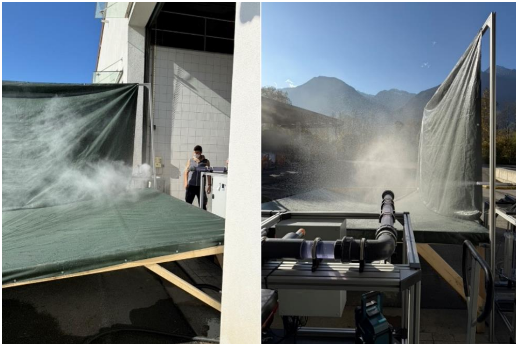
Abbildung 2.4.12: Zusammenführung der Düseninheit und der Dosiereinheit zur Bestimmung des Abscheideverhaltens des Sprühnebelsystems
