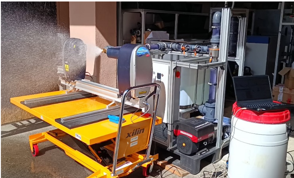
Abbildung 2.4.2: umgesetzter Aufbau zur laseroptischen Messung von Tröpfchengrößen nach einer Düse
